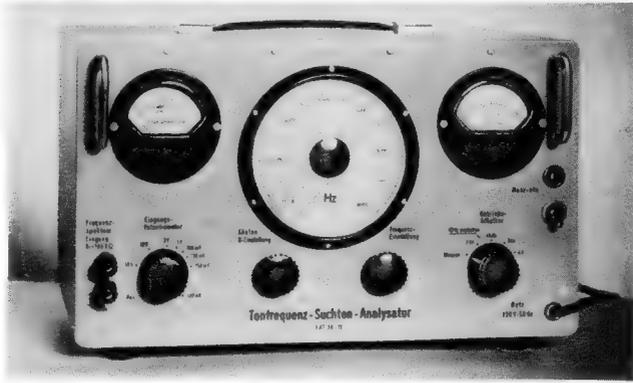
Bild 3. Einfacher Suchton-Analysator der Fa. G. Koller
